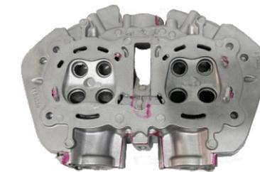
**Головка блока цилиндров мотора мотоцикла**
