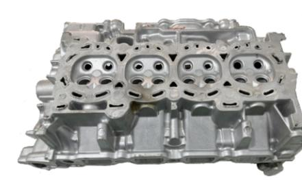
**Головка блока цилиндров двигателя**
